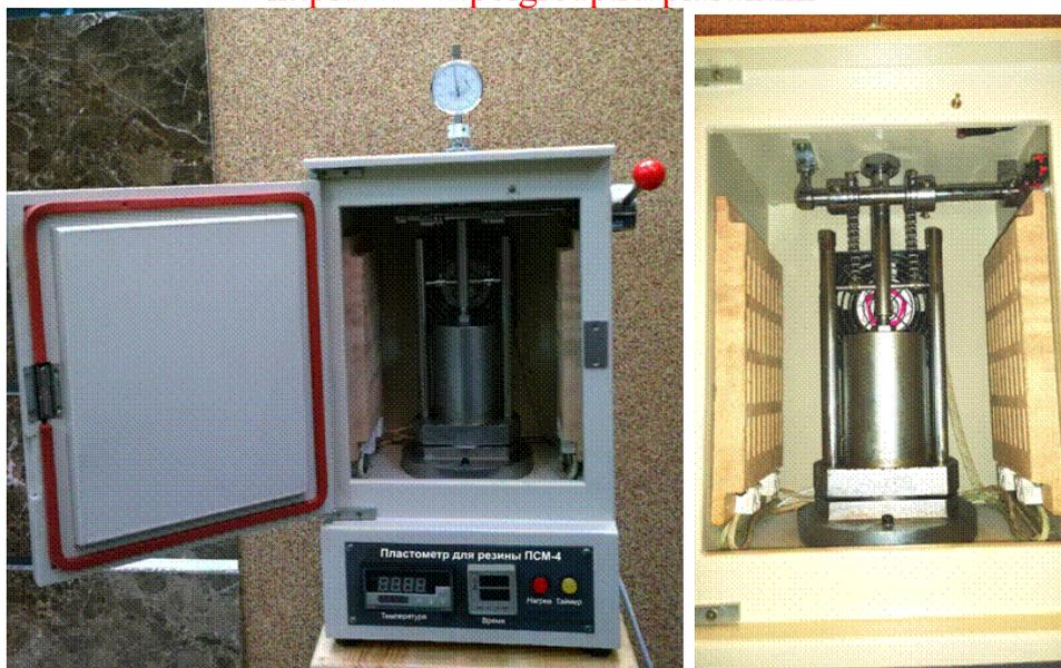
Пластометр предназначен для тестирования пластичности резиновых образцов под нагрузкой 100N или 49N. Сущность метода заключается в сжатии образца между двумя плоскопараллельными плитами под постоянным грузом при заданной температуре и измерении высоты образца до приложения груза, под грузом и после снятия груза и «отдыха». Далее производят вычисления Пластичности, мягкости, «восстанавливаемости», эластичное восстановление R и относительное восстановление R.
